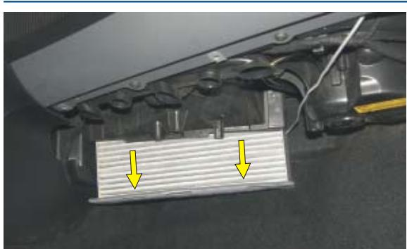
(PL) Wyjąć zużyty filtr, zamontować nowy, wykonać wszystkie powyższe czynności w kolejności odwrotnej
